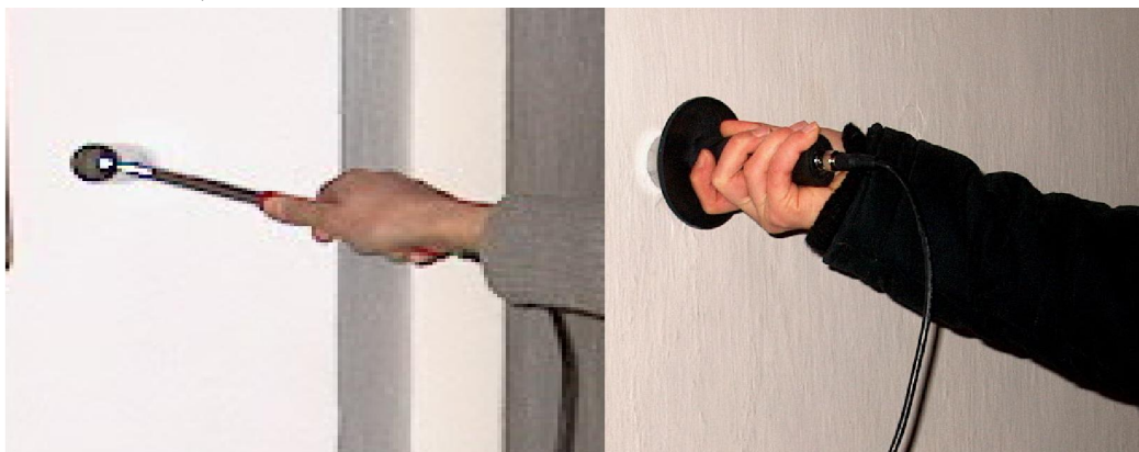
Fig.2 – Strumenti per l'indagine sonora: martello strumentato e sonda ricevente
