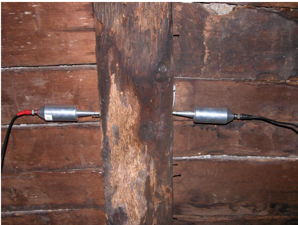
Fig.3 – Strumento ad ultrasuoni per il legno
